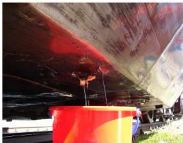
Fig. 8 – Lovirea suportului de repaus al rezervorului, din spate sens mers și spargerea rezervorului
