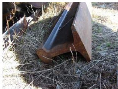
Fig. 2 – Urme de lovire și de scurgeri de motorină pe cuponul de șină
