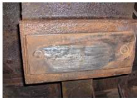
Foto 3: Uzura pietrei de frecare superioară partea dreaptă la primul boghiu în sensul de mers
