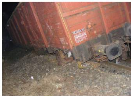
Foto 2 : Vagonul seria Eacs nr. 31535475910-4 deraiat
