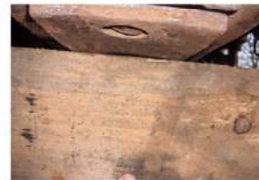
Foto 3: Uzura pietrei de frecare superioară partea dreaptă la primul boghiu în sensul de mers
